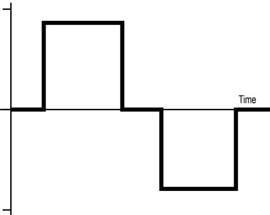
Modified Sine Wave / Módosított szinusz hullám / Modifikovaná sinusová vlna / Undă sinusoidală modificată / Modifikovaní sinusni signal / Modifikovaná sinusová vlna / Modificirani sinusni val
