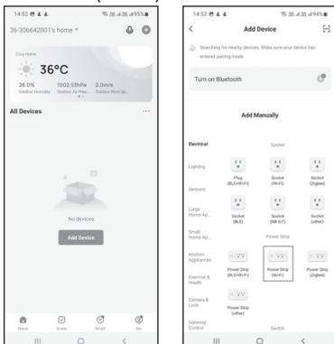
6. Győződjön meg róla, hogy az okostelefon és a WiFi aljzat ugyanabban a 2,4G WiFi hálózatban van. A kapcsolódási folyamat kb. 30-120 másodpercet igényel, a hálózat állapotának és a WiFi jelszó hosszának függvényében.
